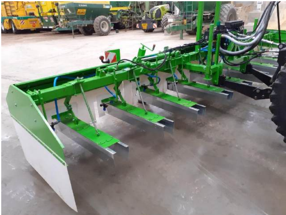
Voorbeeld van een spuit onder overkapping. © Deruyttere.
